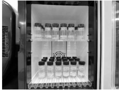
写真2) 手順2 恒温槽で保存される酵母液
