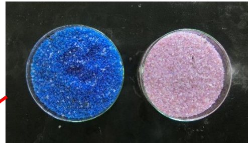
図 7 デシケーターの下部分に入っているシリカゲルが水分を吸収する前後の様子
