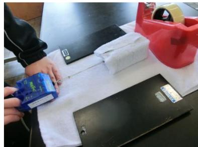
図4 最大摩擦力の実験の様子
