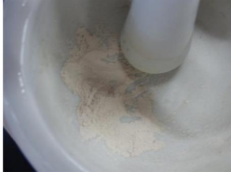
先行研究を改良した点は粉末化である。これは先行研究の通りに水溶液のまま実験を行うと、濃度が低くなってしまふせいか、凝集作用が確認できないことが多かったためである。
