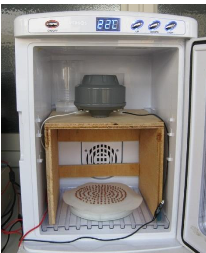
図 4 スピーカーを設置した保冷温庫
