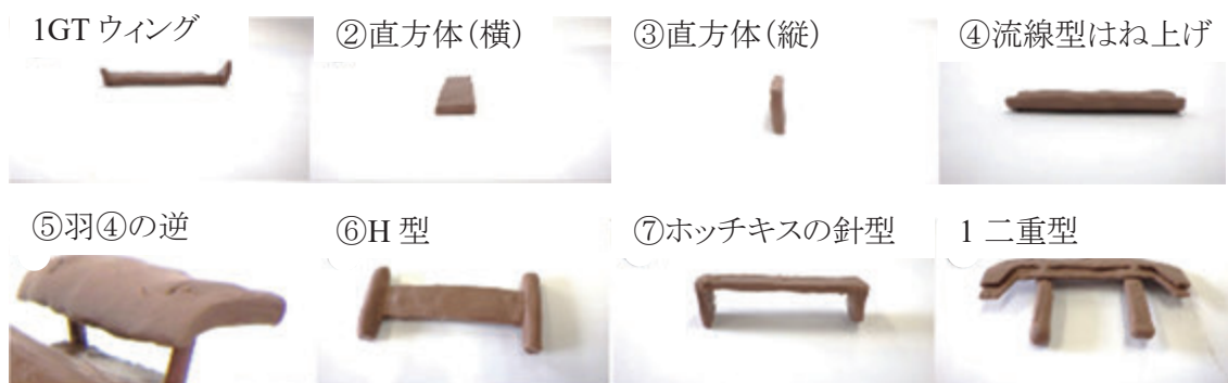
図IV-1 車体に取り付けるリアウィング
